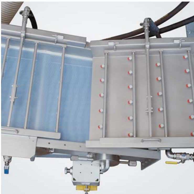
JSG 600的过渡区:料条导向段——输送机
