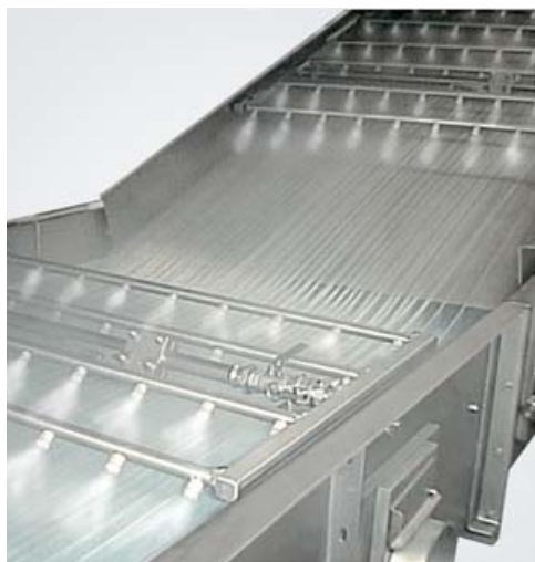
从料条导向段到传送带的过渡区
